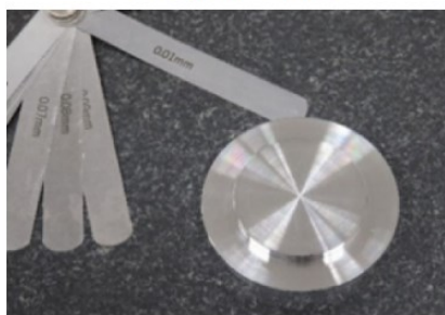
定盤上にてシックネスゲージで検査
