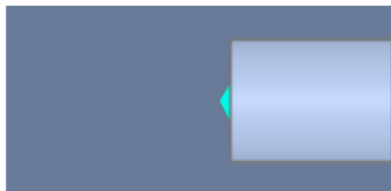
パターンA：ドリル先端形状が残る
