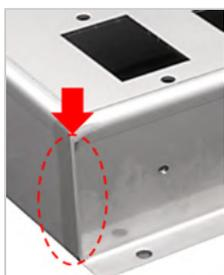
溶接仕上げ：グラインダー仕上げ（SUS304(2B)）
