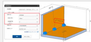
割合で計算 → 一辺あたりの溶接箇所において、選択した割合分が溶接されるように溶接箇所、溶接間隔を調整します。
