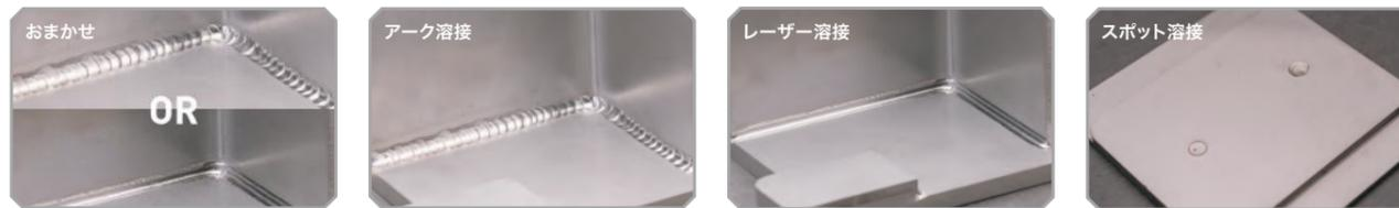
●溶接仕上げ 焼け取りのみ、グラインダー仕上げより選択可能です。例：ステンレス
